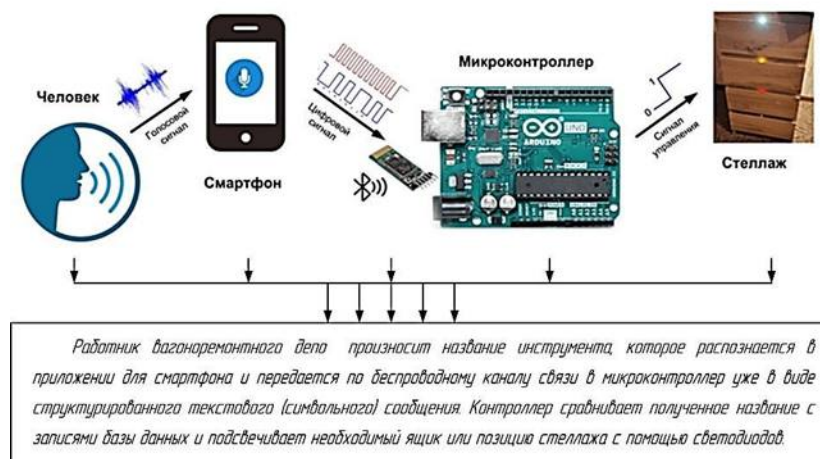
Рис. 1. Блок-схема, описывающая работу основных блоков автоматизированного стеллажа
