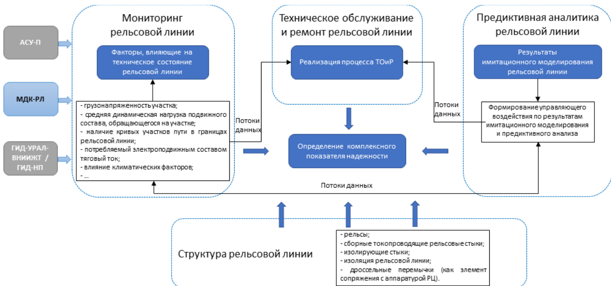
Рис. Интеграция компонентов цифрового двойника рельсовой линии
