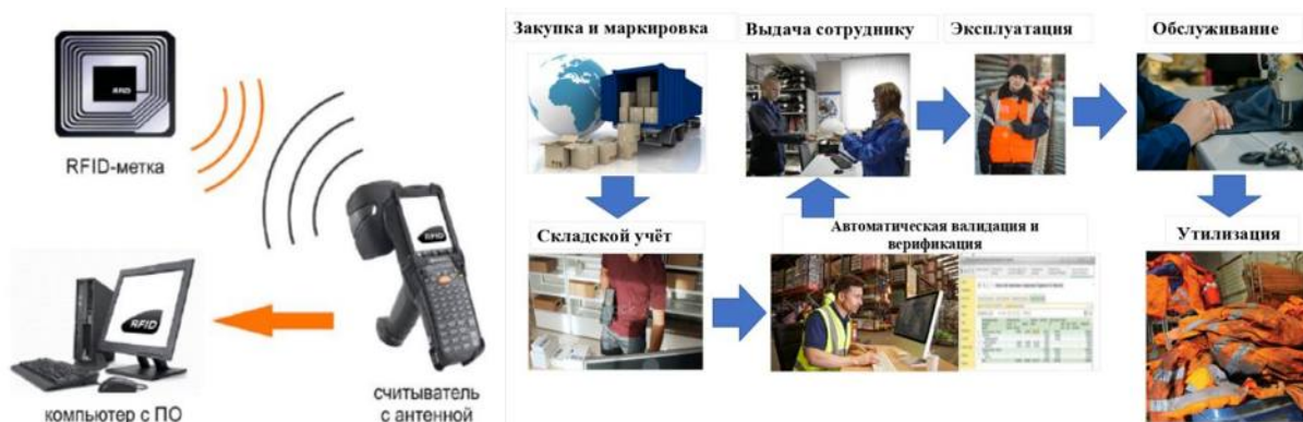
Рис. 4. Схема функционирования автоматизированной системы контроля жизненного цикла форменной, специальной одежды и СИЗ (АС КЖЦОС) на базе RFID-технологий
