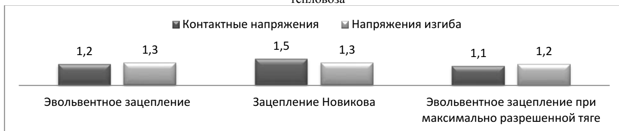
Рис. 3. Гистограмма коэффициентов запаса прочности зубьев тягового редуктора на расчетном режиме
