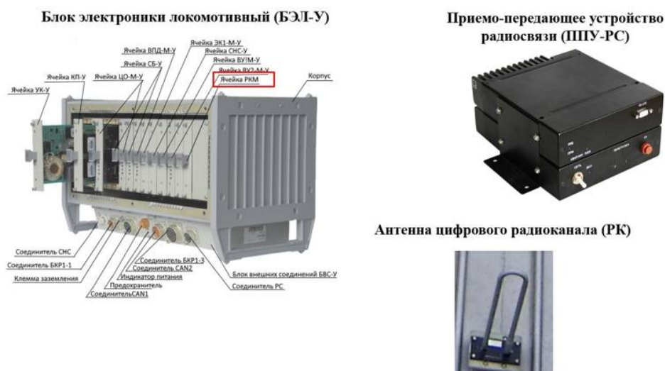
Рис. 2. Элементы КЛУБ-У для обмена информацией по высокочастотному цифровому радиоканалу
