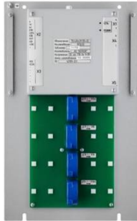
Рис. 1. Внешний вид комплекса расширенной диагностики оборудования электроподвижного состава «КОРД»
