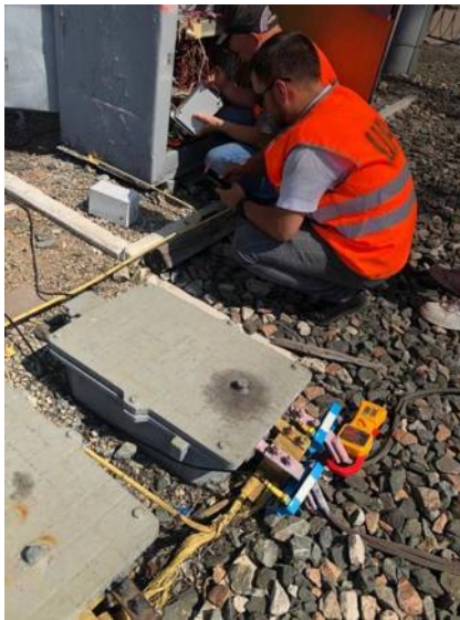
а) подключение токовых клещей и измерительных преобразователей к дроссельным перемычкам
