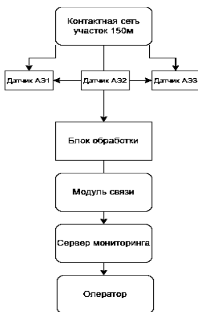
Рис. Структурная схема непрерывной диагностики технического состояния КС методом АС
