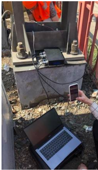
б) мониторинг и сравнение параметров, поступающих с УМ–ТТ и выведенных на монитор ПК
